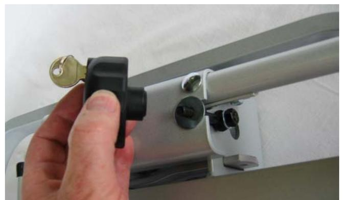
Einstellen der Neigung des Trägers. Dies geschieht mit der rechts gezeigten Schraube. Mutter öffnen, Träger am Wagen festmachen, Neigung wie gewünscht einstellen dann von Hand die Stiftschraube bis zum Anschlag eindrehen, Mutter wieder festziehen.
