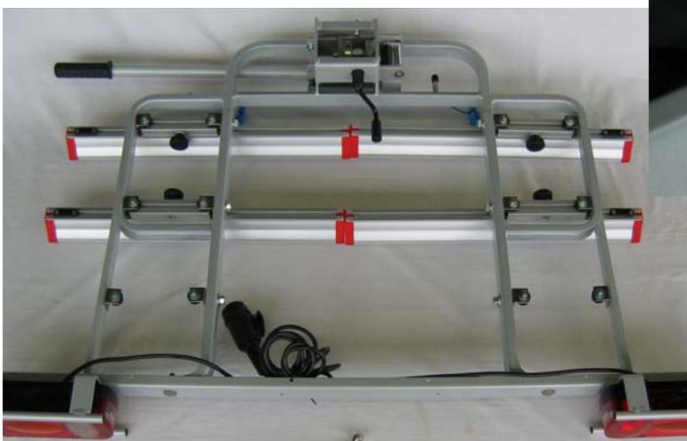
Ihr Träger für 4 Fahrräder sieht nun so aus. Beim Träger für 3 Fahrräder entfallen die beiden äußeren Verlängerungsschienen. Alle Muttern und Schrauben sind nun festgezogen. (links)
