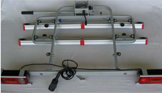
Nachdem Sie beide Verlängerungs-Schienen montiert haben bauen Sie den Leuchtbalken wie abgebildet an. Achten Sie darauf dass die Vierkant-Löcher im Leuchtschutzbügel zur Unterlage hin zeigen. (siehe Bild unten)
