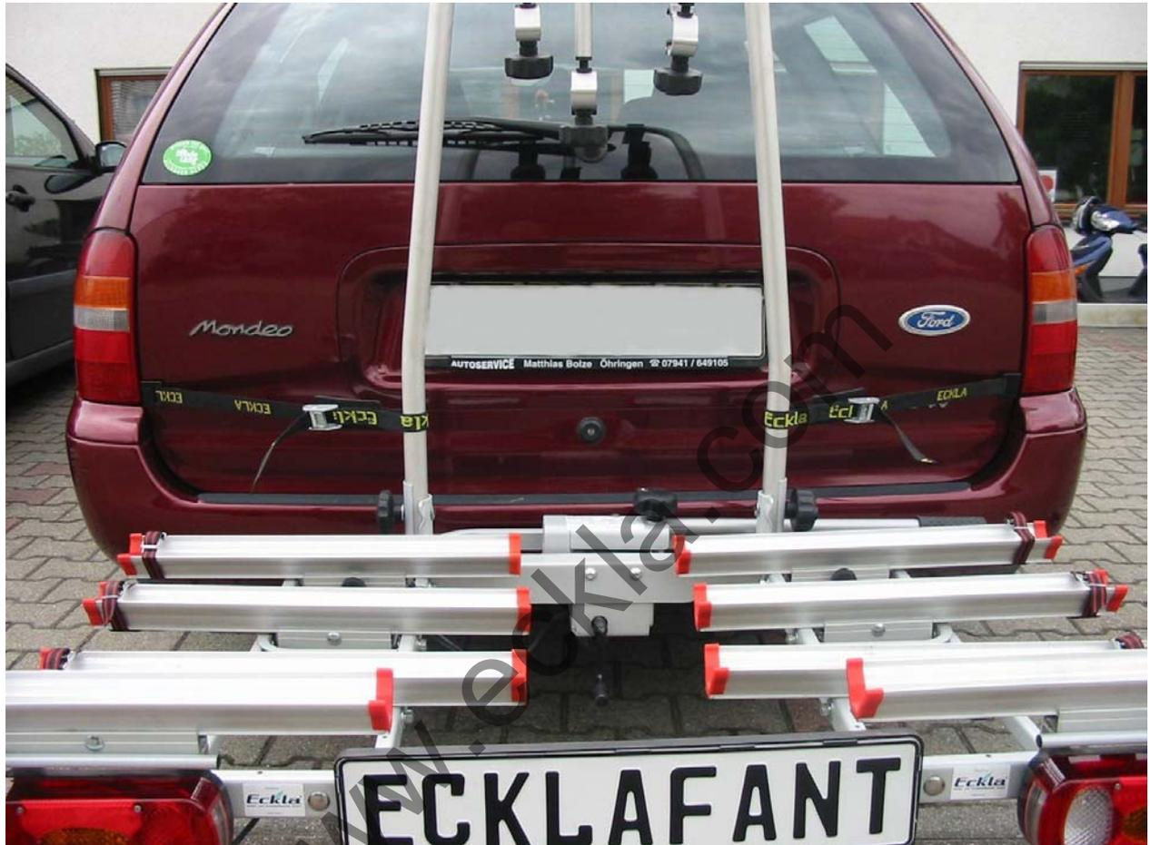
Es ist darauf zu achten, dass die Stabilisierungsbänder so weit wie möglich nach unten angebracht werden. (rechts)
