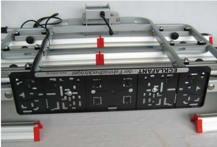
Nun montieren wir auch gleich das Nummernschild aber auf dem Kopf! Hierzu werden die mit zwei Scheiben vormontierten 12mm langen Schrauben aus dem mitgelieferten Schraubenbeutel benötigt. (links)
