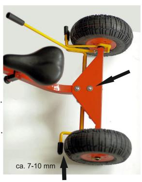
Der kleine Hebel wird als Feststellbremse benutzt. Bitte die Bremse so justieren, dass die Feststellbremse beim hochklappen Wirkung zeigt und das Dreirad bzw. das Dreirad-Bollerwagengespann auch auf abschüssigen Wegen abgestellt werden kann.
