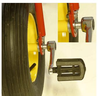
Bei der Montage des Vorderrades ist auf die Laufrichtung zu achten!
