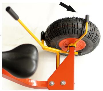
Die Lufträder sind mit den gleichen Ventilen wie am Auto ausgestattet. Luft kann somit an jeder Tankstelle nachgefüllt werden. Der Luftdruck in den Reifen beträgt max. 2 bar.
