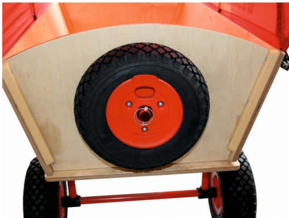
Bitte mit einem Holzbohrer mit Durchmesser 8,0 - 8,5 mm den oben in der Skizze gezeigten Lochabstand in die Stirnseite des Bollerwagens mittig einbringen.
