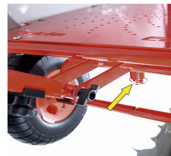
Nachdem Sie die Lenkung aufgesteckt haben bitte mit dem Klappsplint sichern. After you have put on the steering please secure it with the linch pin.
