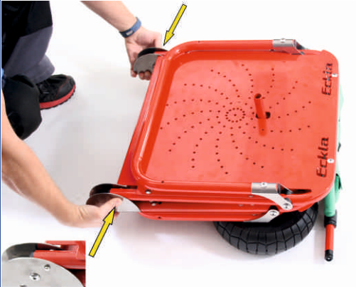
Nun drücken Sie wieder die Rastknöpfe gleichzeitig. Now push the snap buttons together.
