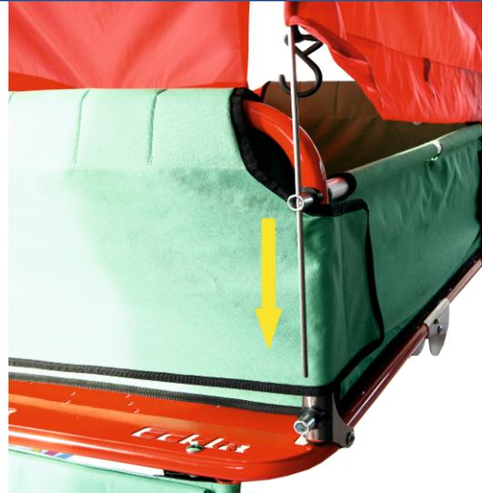
Die Plane jetzt auf die Metallstäbe aufziehen wie auf dem Bild dargestellt und anschließend in die Halterungen einschieben. Die Halterungen wurden ja nur leicht angezogen und können jetzt noch durch drehen korrigiert werden damit die Metallstäbe passen.
