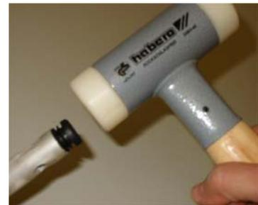
**A.** Stecken sie die Rohrabschlusskappen in die Rohrenden des Zusatzbügels ein und schlagen diese mit Hilfe eines Kunststoffhammers ein.
